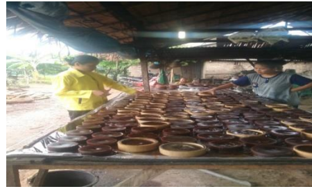
Gambar 3.7. Melepas cetakan Sampel 2
