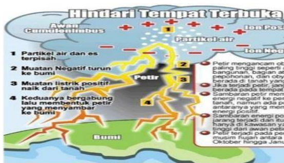
Gambar 1.1 Mekanisme terjadinya petir
