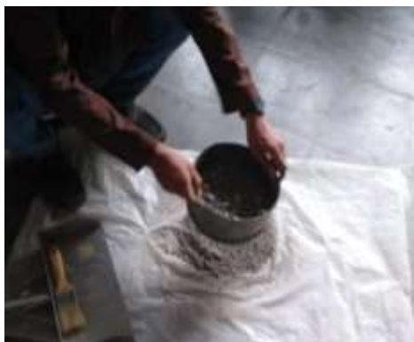
Gambar 4. Proses Pengayakan Breksi Vulkanik Dengan Ayakan Mesh 4.
