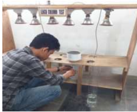
Gambar 7. Penampungan air lindian yang turun dengan gelas ukur.
