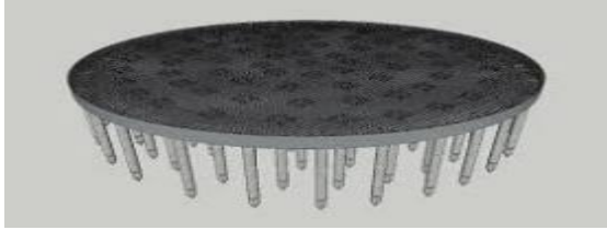
Gambar 11: Ilustrasi pondasi tangki secara struktur setelah di cor
