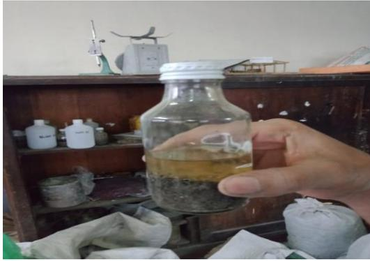
**Gambar 4. Hasil Pengujian Pasir dengan NaOH**
