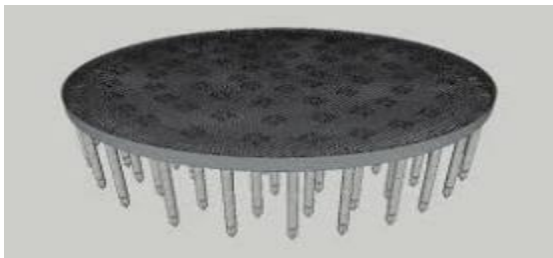
Gambar 11: Ilustrasi pondasi tangki secara struktur setelah di cor
