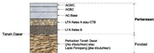
**Gambar 2.3 Struktur perkerasan lentur pada galian (MDP No. 02/M/BM/2017)**
