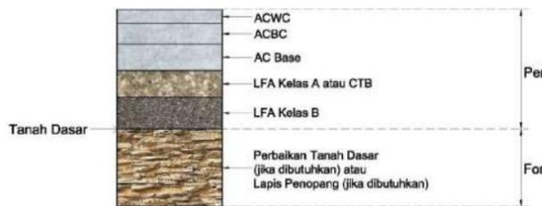
**Gambar 2.1 Struktur perkerasan lentur pada tanah asli (MDP No. 02/M/BM/2017)**
