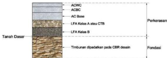
**Gambar 2.2 Struktur perkerasan lentur pada timbunan (MDP No. 02/M/BM/2017)**
