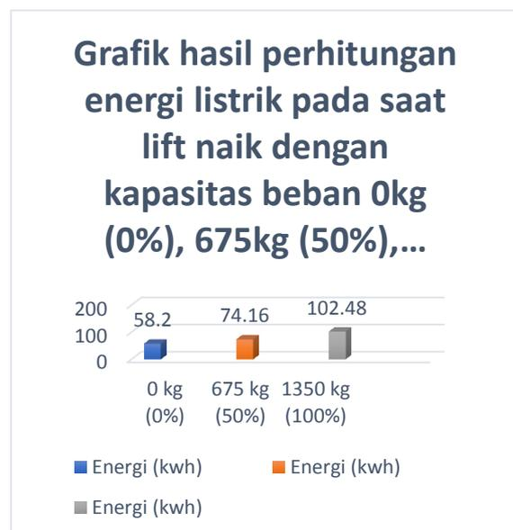
**Gambar 4. 3 Grafik hasil perhitungan energi listrik pada saat lift naik**
