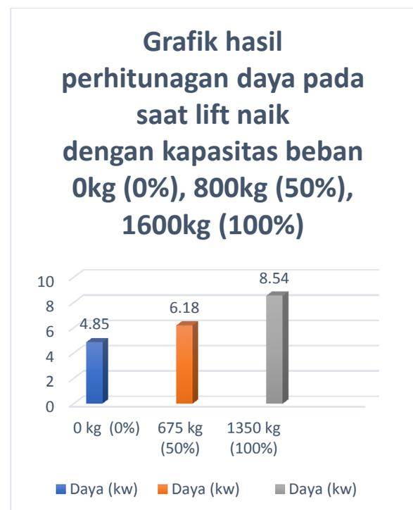
**Gambar 4. 1 Grafik hasil perhitungan daya pada saat lift naik**
