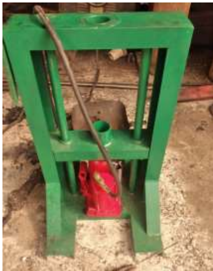
Gambar 1: Alat bantu Service Shock Absorber tipe coil spring menggunakan dongkrak hidrolik otomatis dengan kapasitas 3,5 ton.
