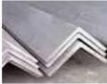
Gambar 3.3 Besi siku ukuran 30 mm x 30 mm x 600 mm jenis ST 37
