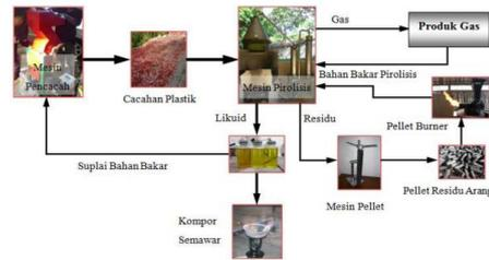
**Gambar 1 : Struktur Integrasi Sistem Pirolisis Sampah Plastik**
